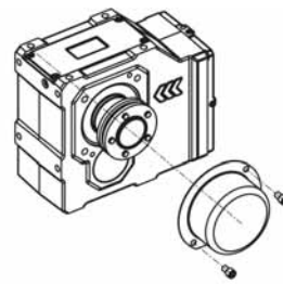
Illustration 10: schéma de principe du réducteur avec capot de protection de frettes de serrage
