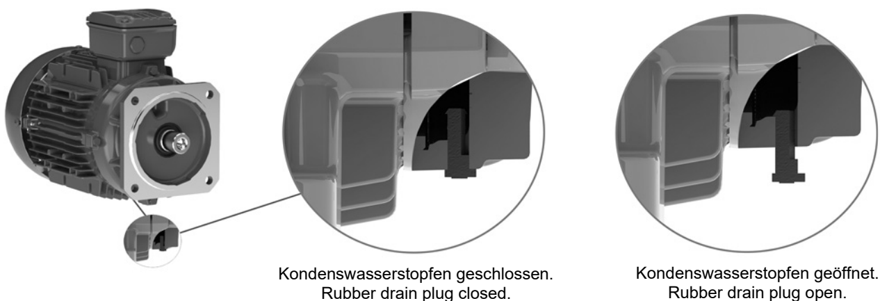
Bild 21: Detail des Kondenswasserstopfens am Lagerschild.
